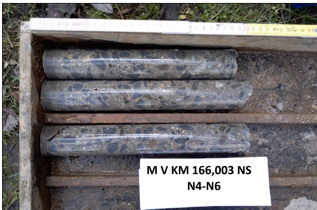
Obr. č. 2 - diagnostické návrty do nosné konstrukce N4 a N6
